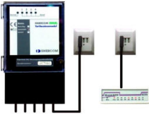
Dieser speichert viertelstündlich die Zählerstände und übermittelt sie einmal täglich über Telefonmodem an die Leitzentrale im Hochbauamt.
