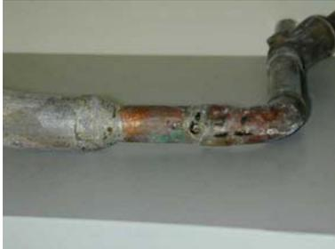
**Rohrverbindung zwischen einem Bleirohr und einem Kupferrohr:**
