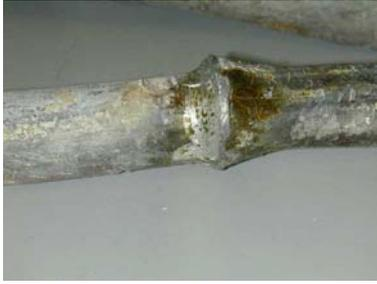
**Rohrverbindung von zwei Bleirohren gleichen Durchmessers:**
