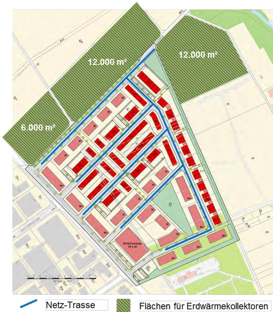
Abb. 137: Schematische Darstellung des möglichen Trassenverlaufs sowie potenzieller Flächen für Erdwärmekollektoren der Variante „NW EWK-WP“ für das Gebiet Südl. Am Riedsteg.
