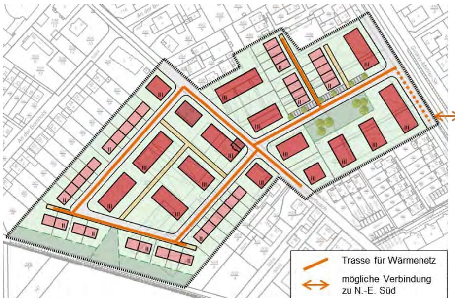
Abb. 153: Schematische Darstellung des möglichen Trassenverlaufs des Nahwärmenetzes der Variante „NahW+ST“ für das Gebiet N.-E.-Am Hollerbusch.
