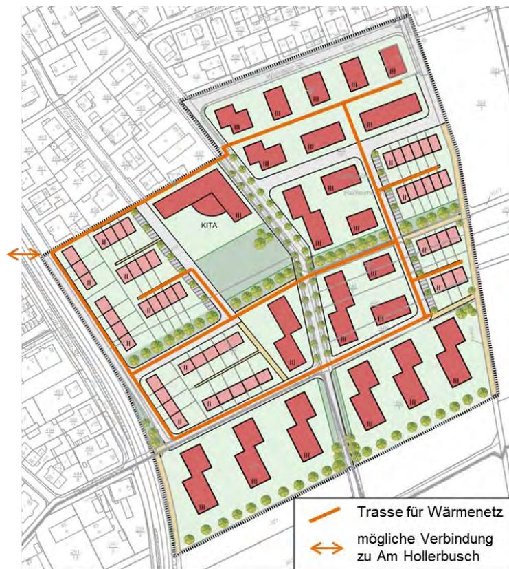
Abb. 171: Schematische Darstellung des möglichen Trassenverlaufs des Nahwärmenetzes der Variante „NahW+ST“ für das Gebiet Nieder-Eschbach Süd.
