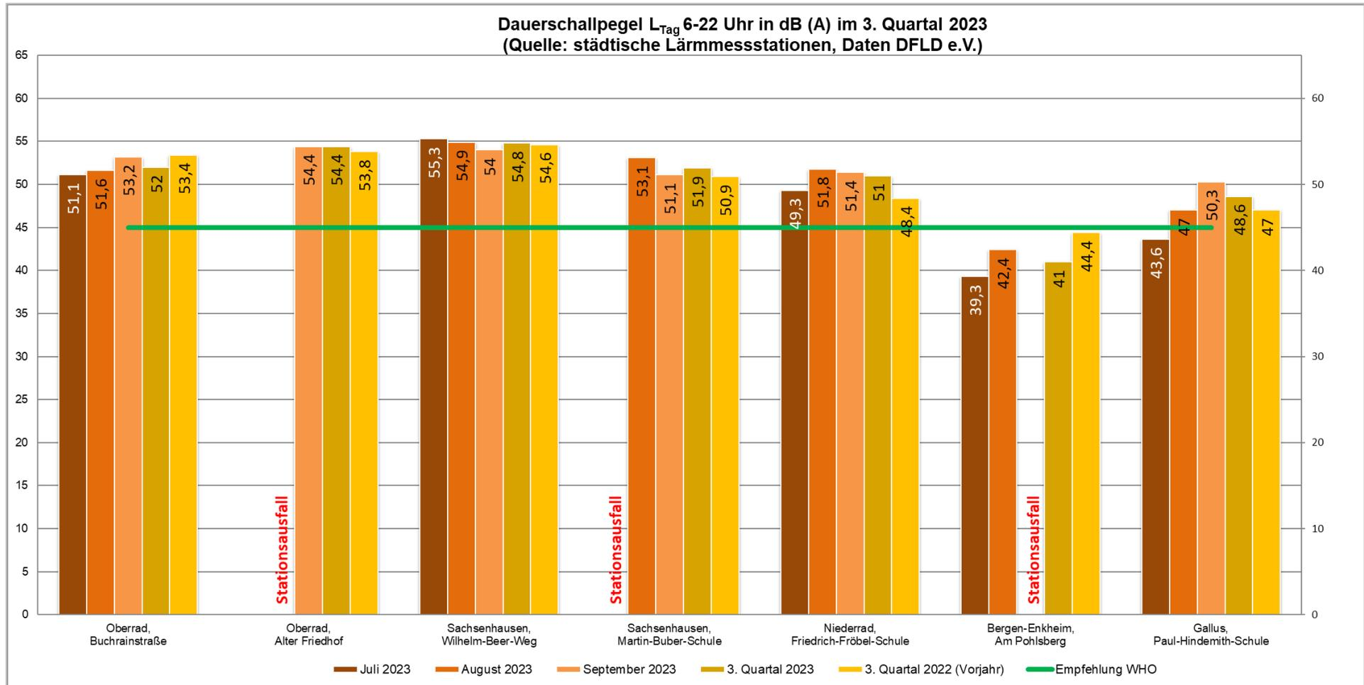
Diagramm 3: Dauerschallpegel  $L_{\text{Tag}}$  der städtischen Lärmessstationen im 3. Quartal 2023 im Vergleich zum 3. Quartal 2022
