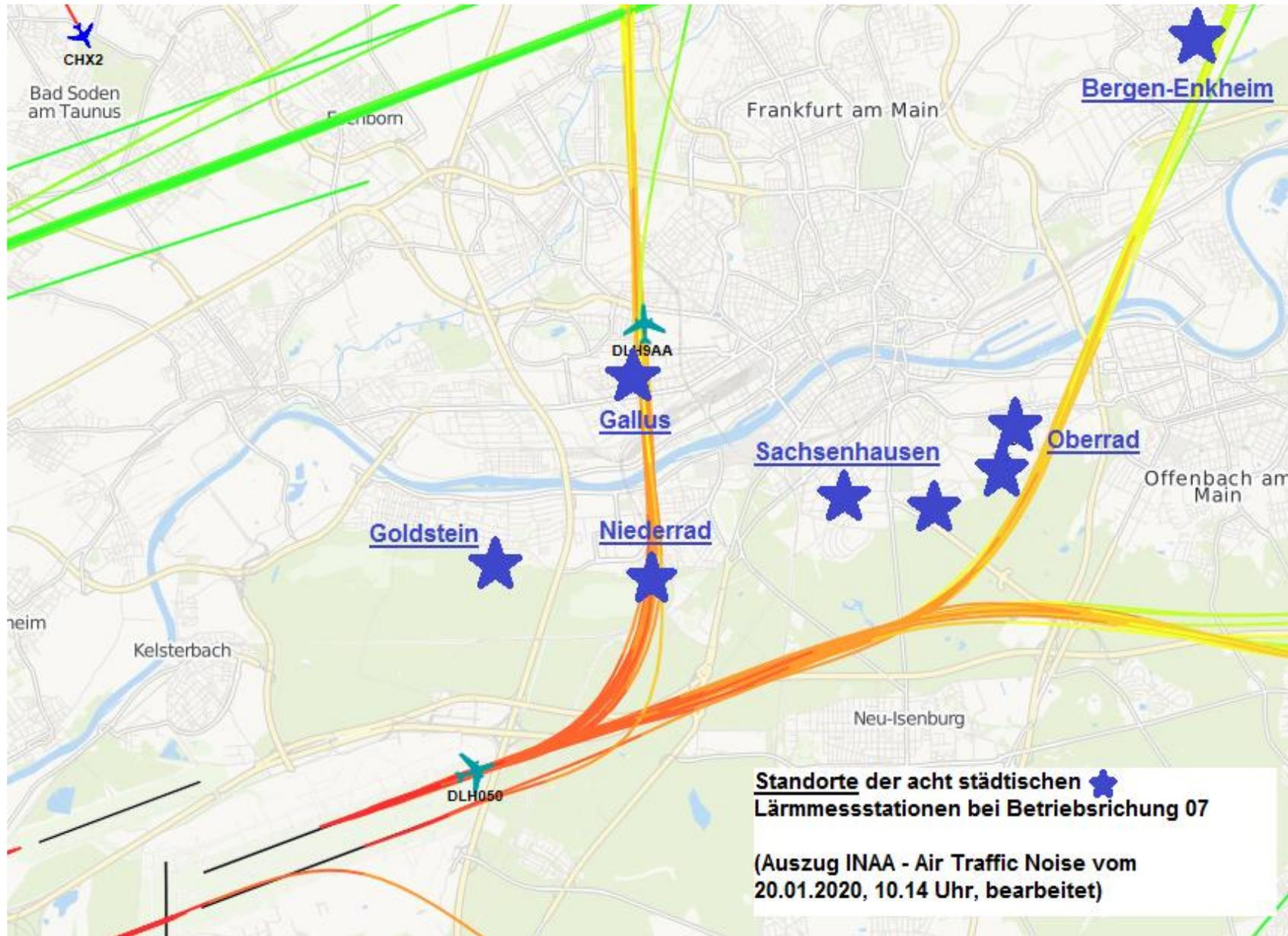
Abbildung 3: Standorte der städtischen Lärmmessstationen bei Betriebsrichtung 07, Ansicht mit 4h-Flugspuren (Auszug INAA – Air Traffic Noise vom 20.01.2020, 10.14 Uhr, bearbeitet, nicht maßstabsgerecht)
