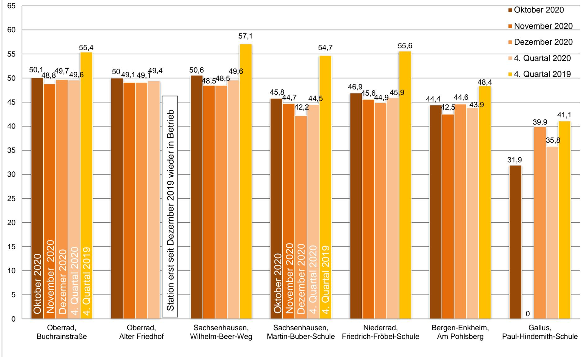
Diagramm 3: Dauerschallpegel  $L_{Tag}$  der städtischen Lärmmessstationen im 4. Quartal 2020 im Vergleich zum Jahr 2019
