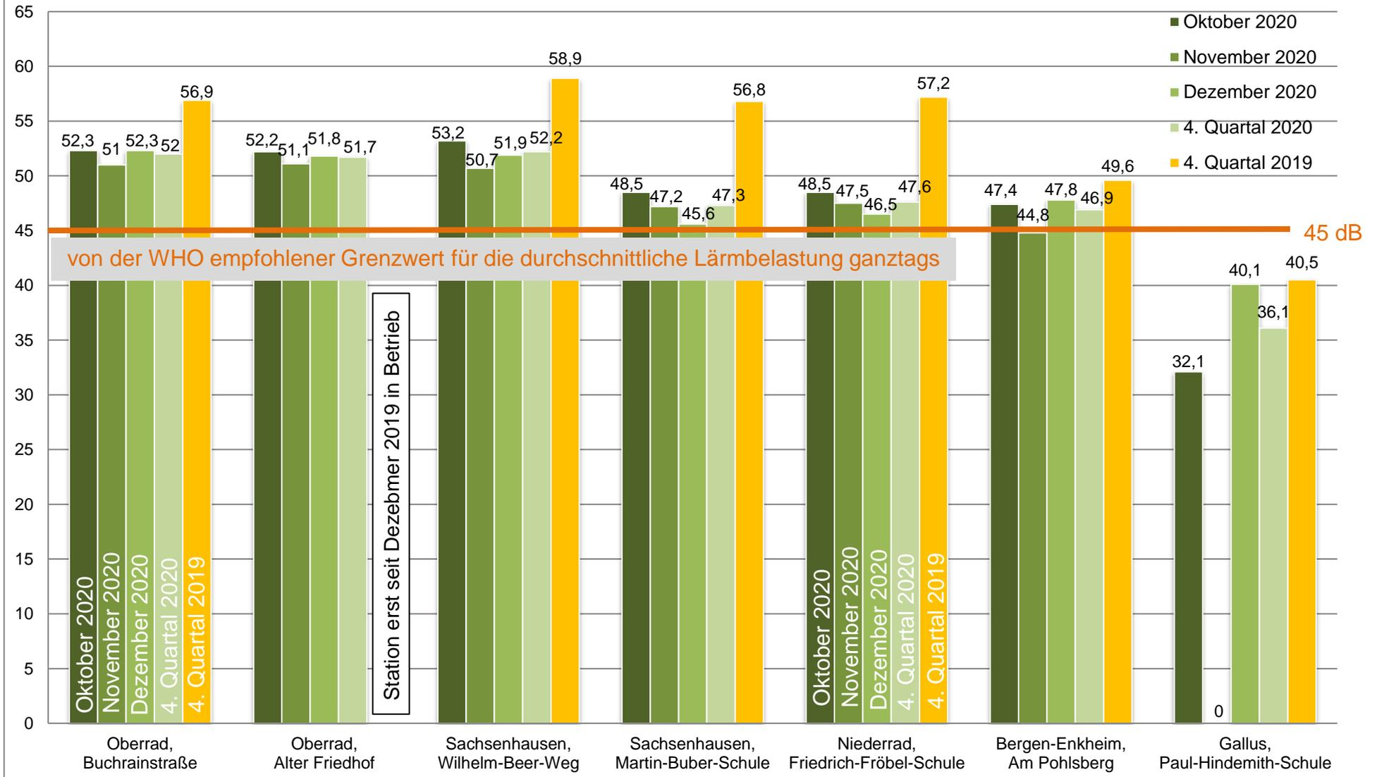
Diagramm 5: Dauerschallpegel  $L_{den}$  der städtischen Lärmmessstationen im 4. Quartal 2020 im Vergleich zum Jahr 2019
