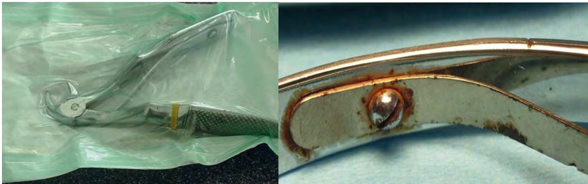
Abb. 66: Beispiele für nicht sachgerechte Medizinprodukte-Aufbereitung in der Zahnarztpraxis: zu eng bemessene Sterilgutverpackung (links), unsachgemäß aufbereitetes und gepflegtes Medizinprodukt mit Rost und Lochkorrosion (rechts)
