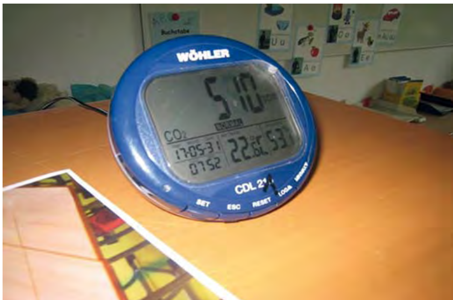
Abb. 72: Kohlendioxidmessung mit dem Wöhler-Messgerät
