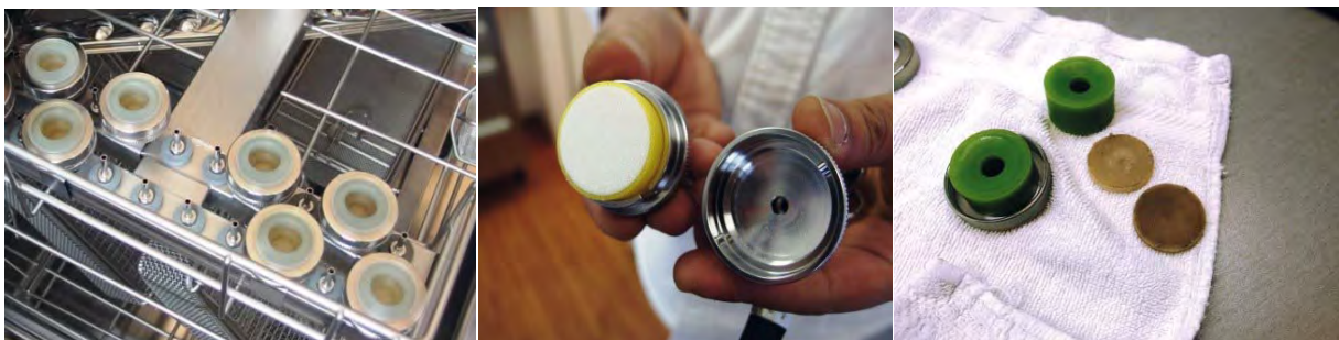
Abb. 67: Beispiel für maschinelle Aufbereitung von Übertragungsinstrumenten (Turbine/ Hand- und Winkelstücke) mittels Konnektoren/ Adaptern (links) und sauberen Filtern (Mitte) sowie verdreckten Filtern (rechts)
