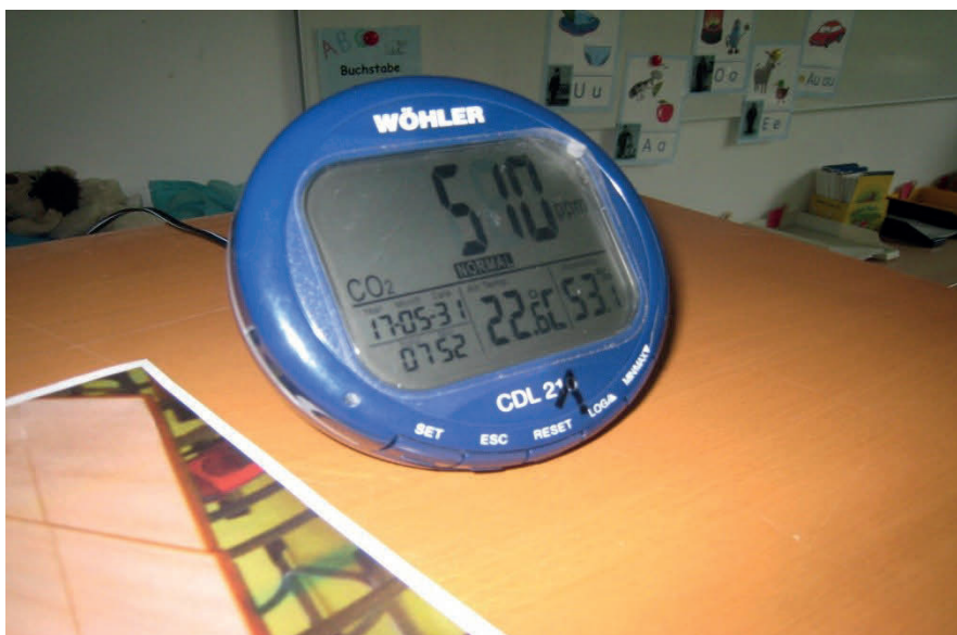
Abb. 5 Kohlendioxidmessung mit dem Wöhler-Messgerät
