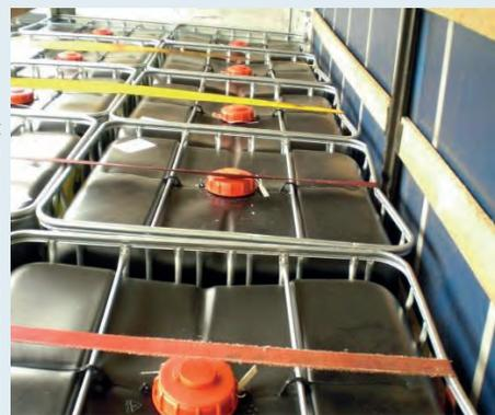
Das Gefahrgut: 10 IBC mit UN 1866 Harzlösung, Gefahrzettel 3, Verpackungsgruppe II, Tunnelcode D/E. Die außenstehenden IBC wurden durch die Zurrgurte am oberen Rand des Metallrahmens stark beschädigt, sodass ein Stapeln der IBC nicht mehr möglich und somit deren Baumusterzulassung nach den Gefahrgutvorschriften erloschen ist.
