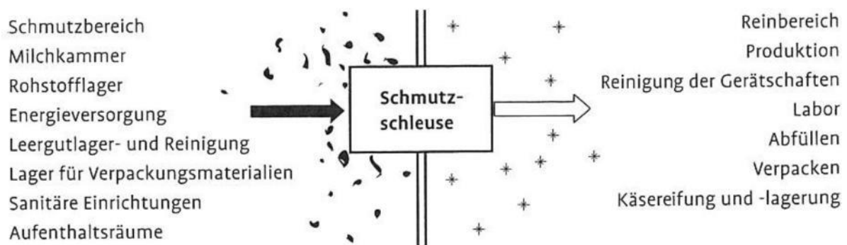
Abbildung 1: unreiner und reiner Bereich
