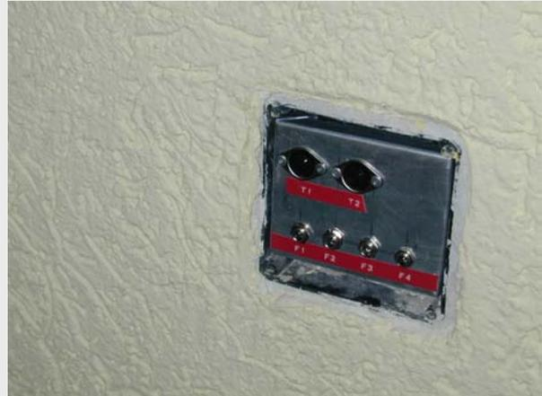
**Bild 38:** Probemessungen für Feuchte (links) und Temperatur (rechts)
