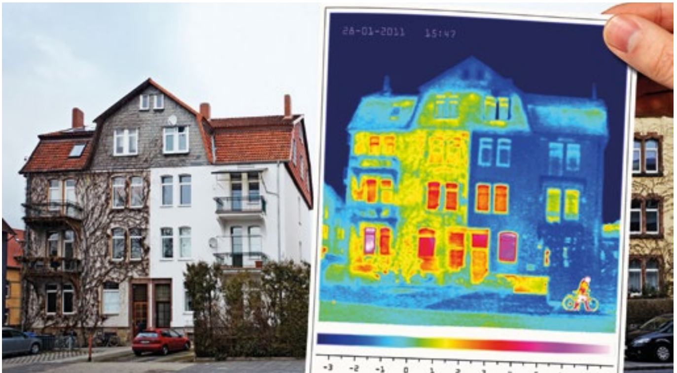
Abbildung 5: Thermografieaufnahme mit Darstellung der energetischen Schwachstellen (Foto: Ingo Bartussek – Fotolia.com )
