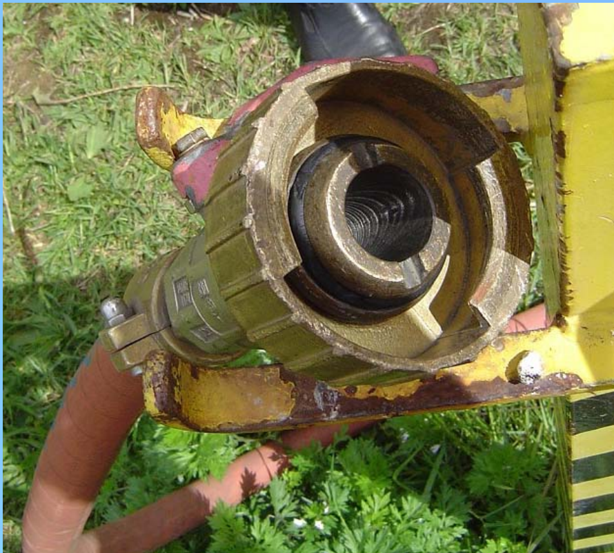
Schutzkappe fehlt (überwiegende Beanstandungsart)
