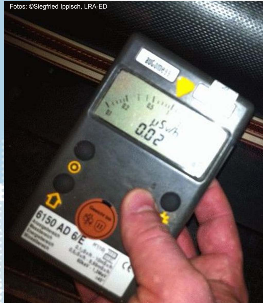
automess 6150 AD 6/E, S/N 80512 Dosisleistung*
