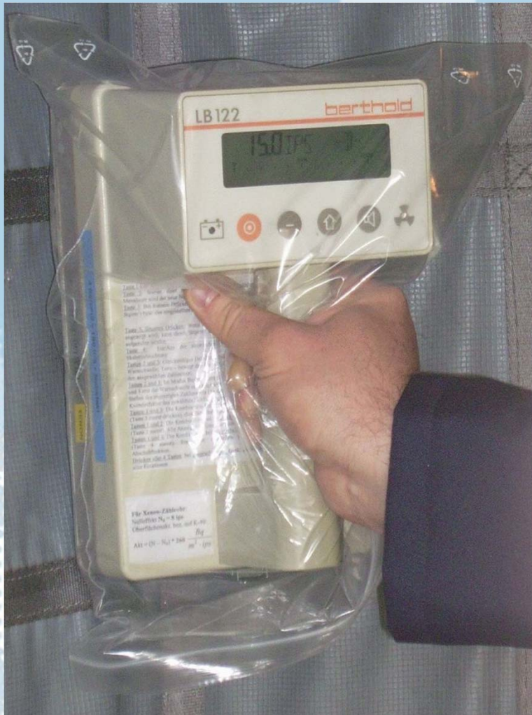
berthold LB 122 Kontamat 26 Alpha-Beta-Detektor*
