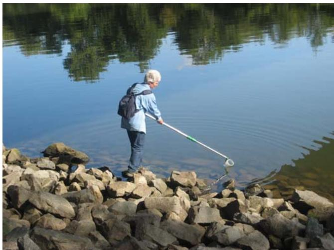
Mittels einer Probenahmestange werden die Proben in ca. 1 m Entfernung vom Ufer, kurz unterhalb der Wasseroberfläche, in eine sterile 1-Liter-Klarglasflasche abgefüllt und umgehend an das Untersuchungsinstitut weitergeleitet.
