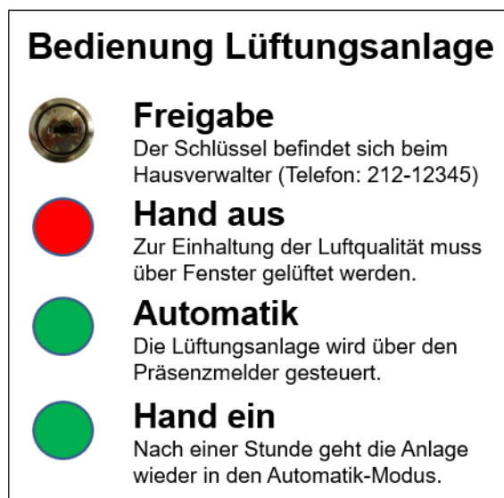
Handbedienebene Lüftungsanlage Darstellung: ABI, Abteilung Energiemanagement
