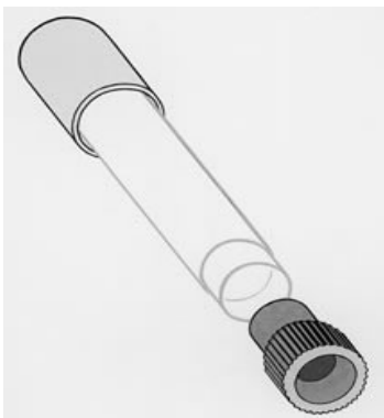
Abbildung 5: Schematischer Aufbau eines Passivsammlers für Stickstoffdioxid: der obere Teil enthält das Adsorbens Triethanolamin, welcher von unten durch einen Stöpsel mit einer Glasfritte definierten Durchmessers gegen groben Schmutz geschützt wird. (Bild: passam ag)
