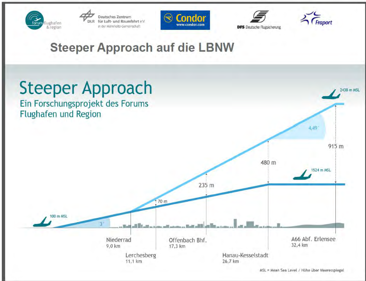
Abbildung 37: Steeper Approach auf die Nordwestlandebahn
