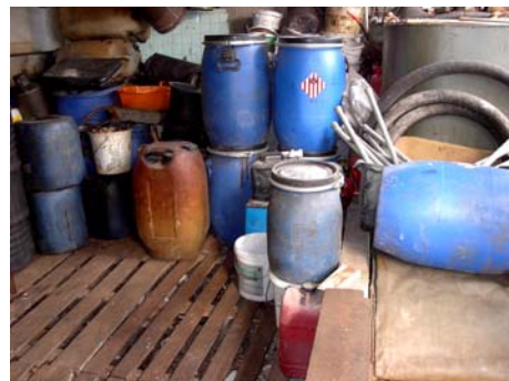
Unsachgemäße Lagerung wassergefährdender Stoffe
