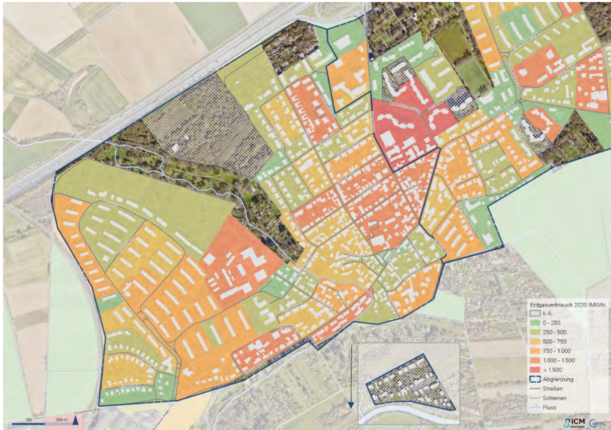
Abbildung 15: Räumliche Darstellung des tatsächlichen Erdgasverbrauchs (Datenquelle: Mainova 2020, Luftbilder 2019 der Stadt Frankfurt am Main)
