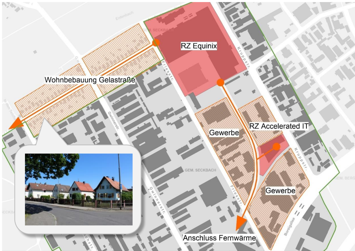
Abbildung 28: Skizze Abwärmenutzung Rechenzentren
