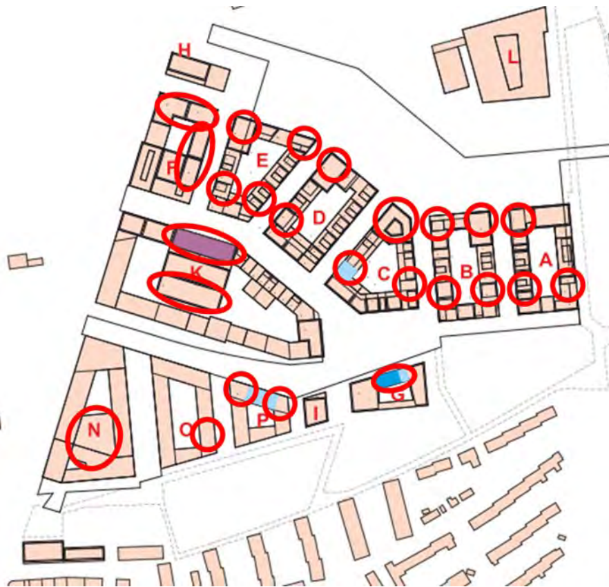
Abb. 54: Gebäudebereiche, die sich nur bedingt für eine wirtschaftliche Erstellung im Passivhaus-Standard eignen.
