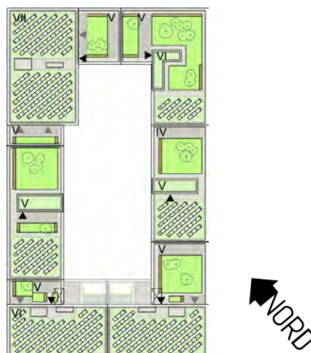
Abb. 56: Exemplarische Darstellung des Dachflächenkonzepts für einen geplanten Wohnblock. (Quelle: Bürogemeinschaft Kölling und Crossboundaries Architekten)
