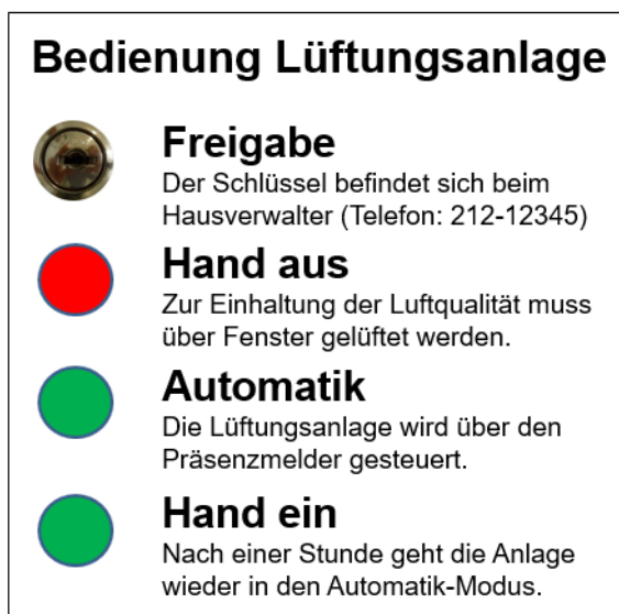
Handbedienebene Lüftungsanlage Darstellung: ABI, Abteilung Energiemanagement
